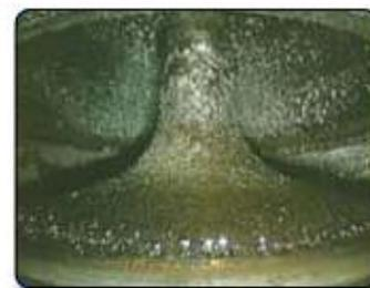
Cette soupape d'admission observée sur le cylindre ayant utilisé le carburant sans plomb ordinaire est fortement encrassée par des dépôts d'oxydation noirâtres. Après 5000 km avec du carburant sans plomb ordinaire (Constaté sur les véhicules testés).
