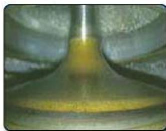
Cette soupape d'admission observée sur le cylindre ayant utilisé le carburant BP Ultimate SP 98, après 5000 km, conserve un état presque neuf.
